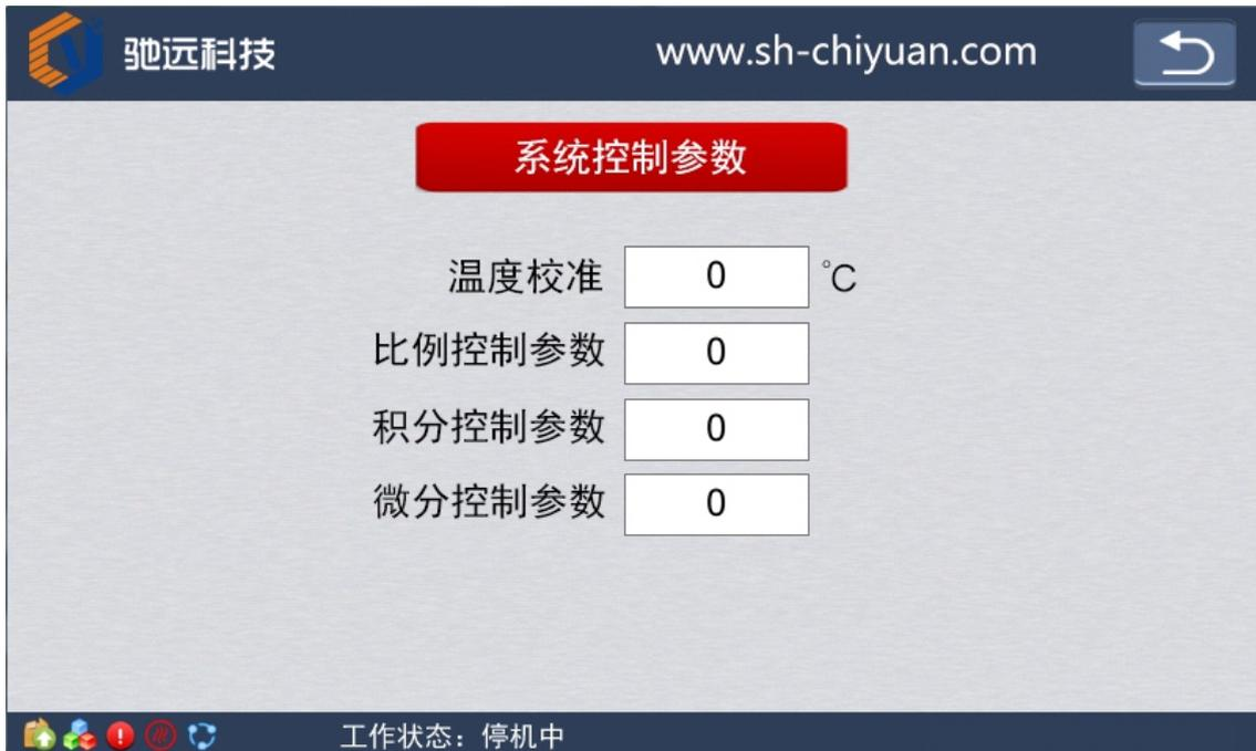
**温度校准：**当热电偶的测温与实际温度有偏差时，可通过此参数正负数值进行校准，一般在机器启动之前，与室温进行校准。
